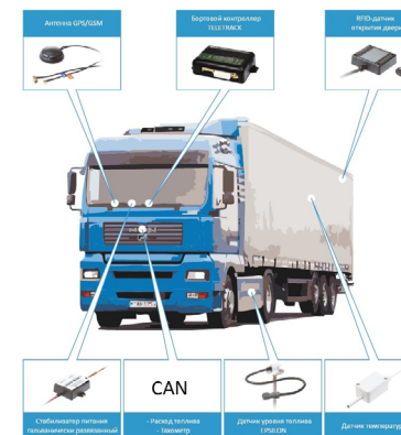
Рисунок 2 - Расположение датчиков слежения на транспортном средстве [8]
