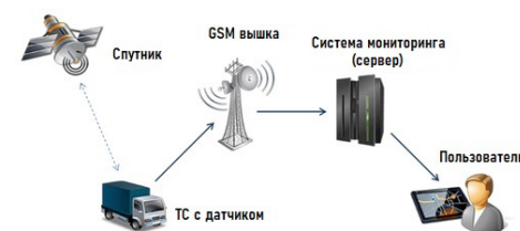
Рисунок 1 Схема работы системы мониторинга за транспортным средством.
