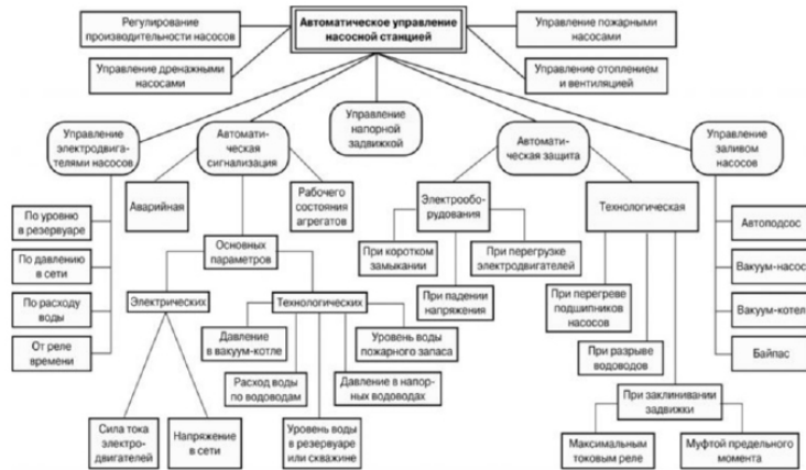
Рисунок 3 – Схема автоматического управления насосной станцией
