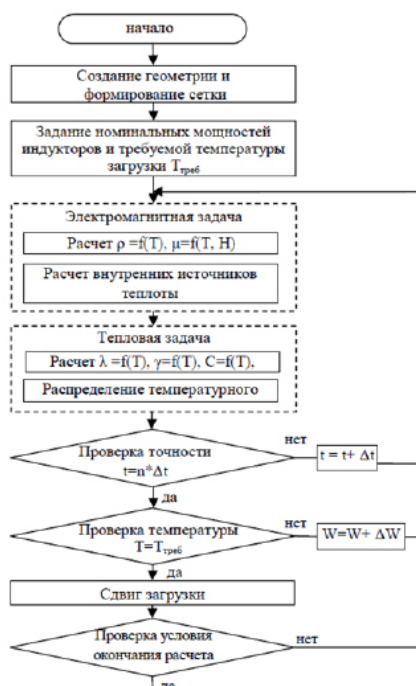
Рисунок 1 – Алгоритм совместного решения электромагнитной и тепловой зада при индукционном нагреве при наличии системы управления с обратной связью температур
